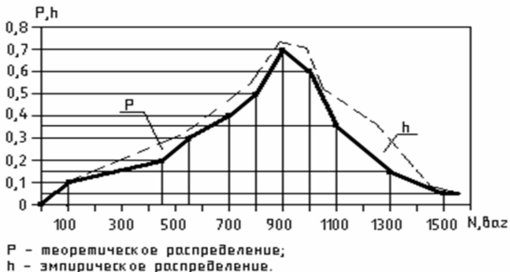
Рисунок 8.6 – График неравномерности поступления вагонов под погрузку
