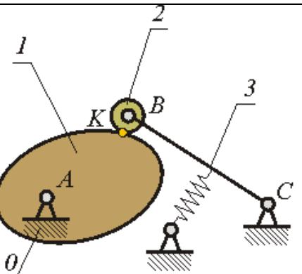
41. Механизм, кинематическая схема которого показана на рисунке, относится к ... механизмам
