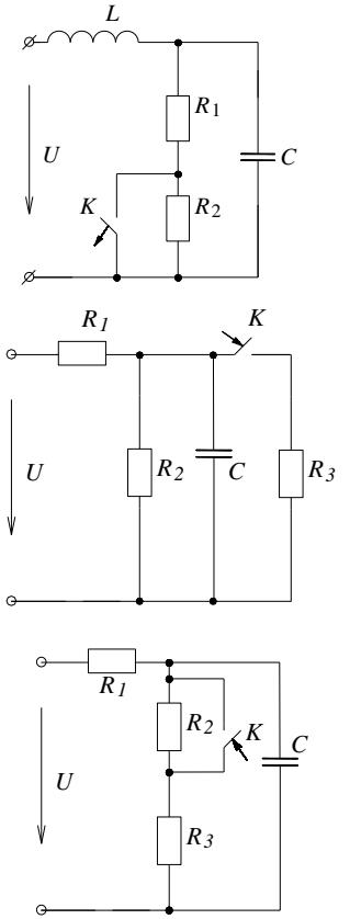
3. Найти уравнения тока и напряжения переходного процесса  $i_c(t)$  и  $U_c(t)$  в электрической цепи после замыкания ключа  $K$ , если к цепи приложено постоянное напряжение  $U=200\text{ В}$ .  $R_1=5\text{ Ом}$ ,  $R_2=5\text{ Ом}$ ,  $R_3=10\text{ Ом}$ ,  $C=100\text{ мкФ}$ . Построить графические зависимости  $i_c(t)$  и  $U_c(t)$ . Задачу решить любым методом.
