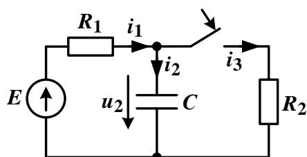
а)  $u_2(+0) = E$ ; б)  $i_1(+0) = 0$ ; в)  $i_3(+0) = E/R_2$ ; г)  $i_2(+0) = -E/R_2$
