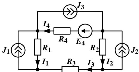
a)  $I_2 + I_4 - J_2 - J_3 = 0$ ; б)  $I_1 + I_4 = J_1 + J_3$ ; в)  $I_1R_1 + I_2R_2 + I_3R_3 + I_4R_4 = E_4$
