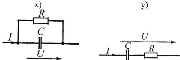
18. Определите формулу для угла диэлектрических потерь конденсатора с малыми потерями.
