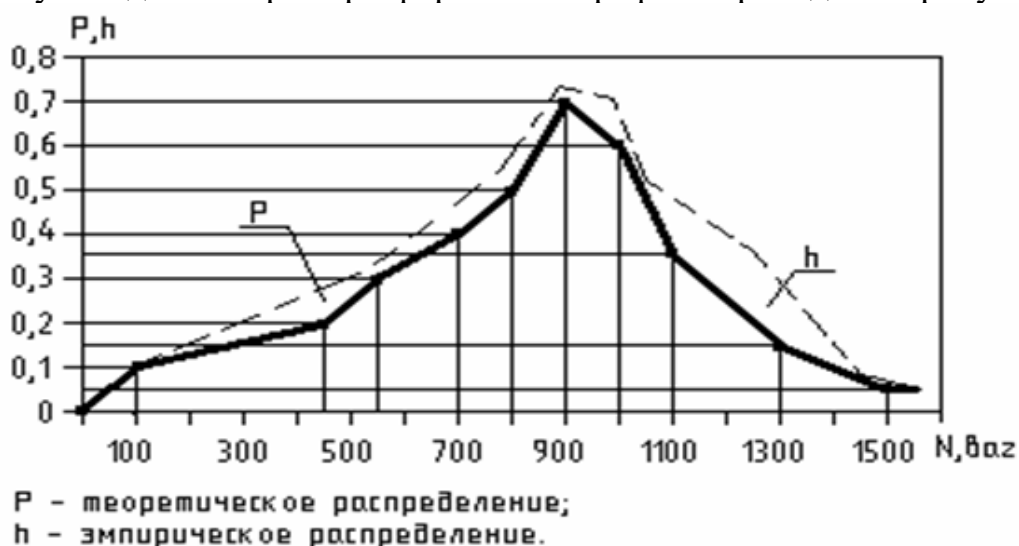
Рисунок 8.8 – График неравномерности поступления вагонов под погрузку
