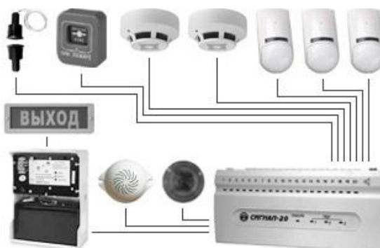
Система охранно-пожарной сигнализации для офиса
